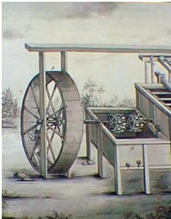
Figura 197. Estampa 6. Fabrica de Bateria de roda
